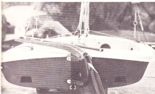
Deux conduits de gros débit assurent l'évacuation de l'eau embarquée à travers le tableau arrière.
